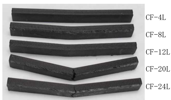
Fig. 15 Onyx0.125mm 繊維材料CFの積層 (L) 数の違いによる3点曲げ試験片
