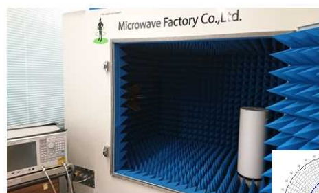
上: マイクロウェーブファクトリー(株)製 アンテナ計測システム 右: アンテナパターンの測定例
