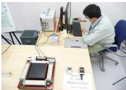
エプスタイン試験器での磁気測定
