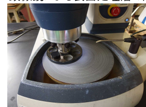
写真2 自動研磨装置による評価面の研磨
