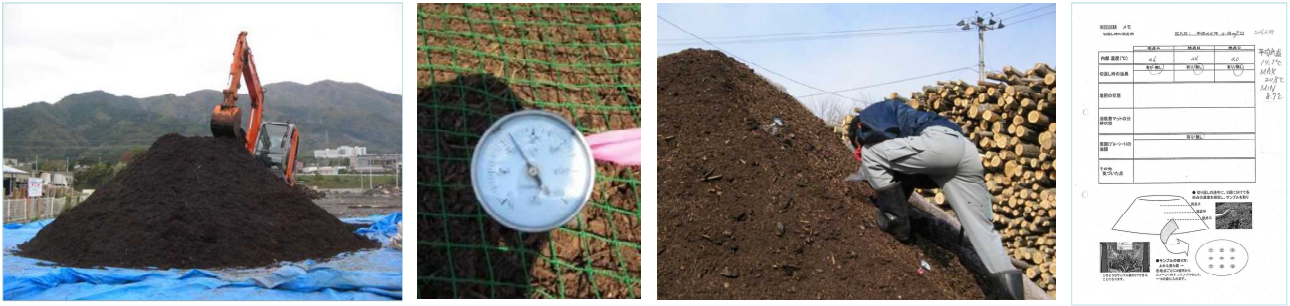
Fig.1 実証試験のバイオ処理風景及びサンプリング測定記録作業
